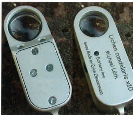
Figur 6. Lichen candelaris sedd underifrån (t.v.) och ovanifrån (t.h.). På den vänstra bilden syns de två lampornas placering.
