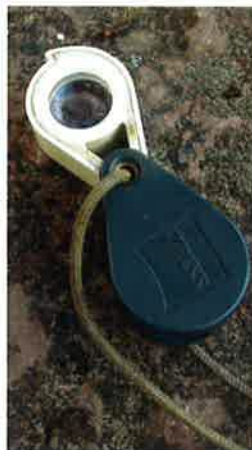
Figur 2. Zeiss 10x. En lätt lupp helt i plast.
