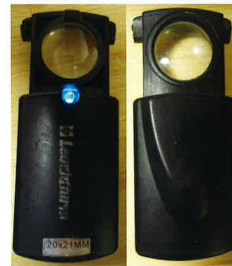
Figur 8. LU 30 LED 20x sedd underifrån med påslagen belysning (t.v.) och ovanifrån (t.h.).
