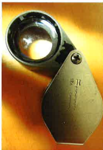
Figur 3. Eschenbach 12x. Här syns att den svarta färgen flagnar av.
